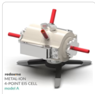
金属离子四点EIS测试池, A型 采用四电极法精确测量材料的体电阻和界面电阻，排除接触电阻干扰。
